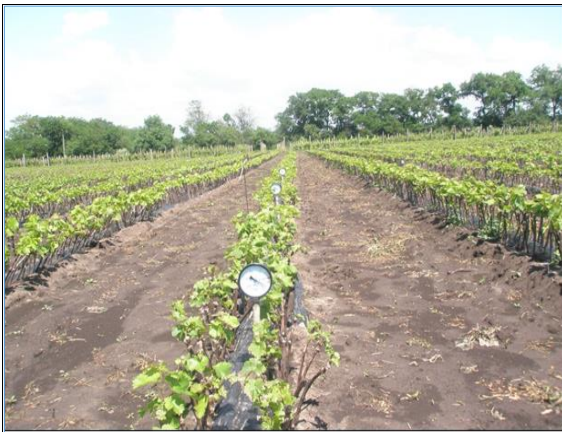
Рисунок 2.2 – Встановлення тензіометрів на виноградній шкільці
