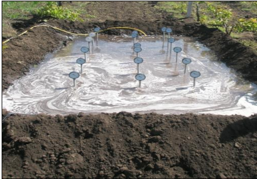
Заливання майданчика з тензіометрами водою
