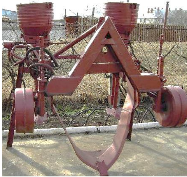
Рис. 2 Глибкорозпушувач РВ-3, обладнаний тукоподаючою системою
